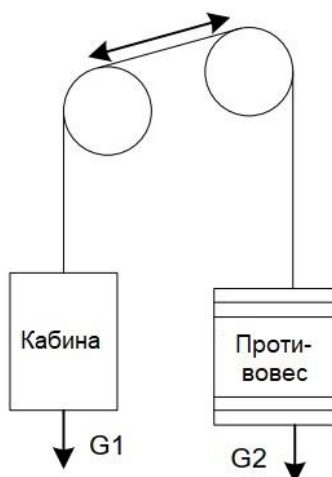
Рисунок 6-4 Связь между нагрузкой кабины и противовесом
