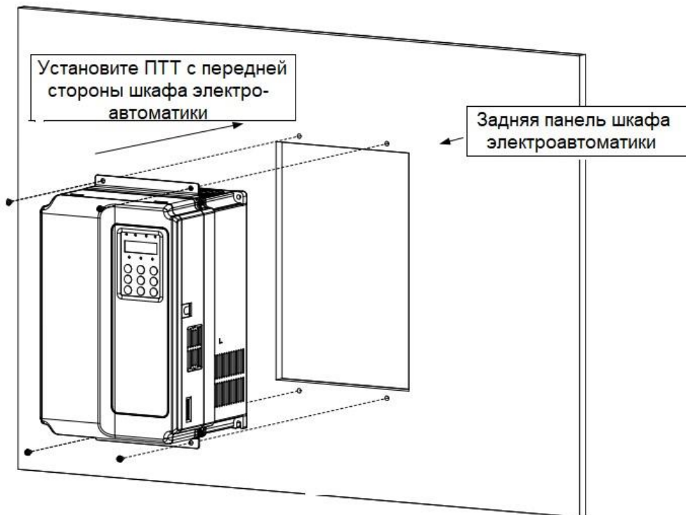
Рисунок 3–4 Сквозной монтаж устройства INVERTER (пластиковый корпус)
