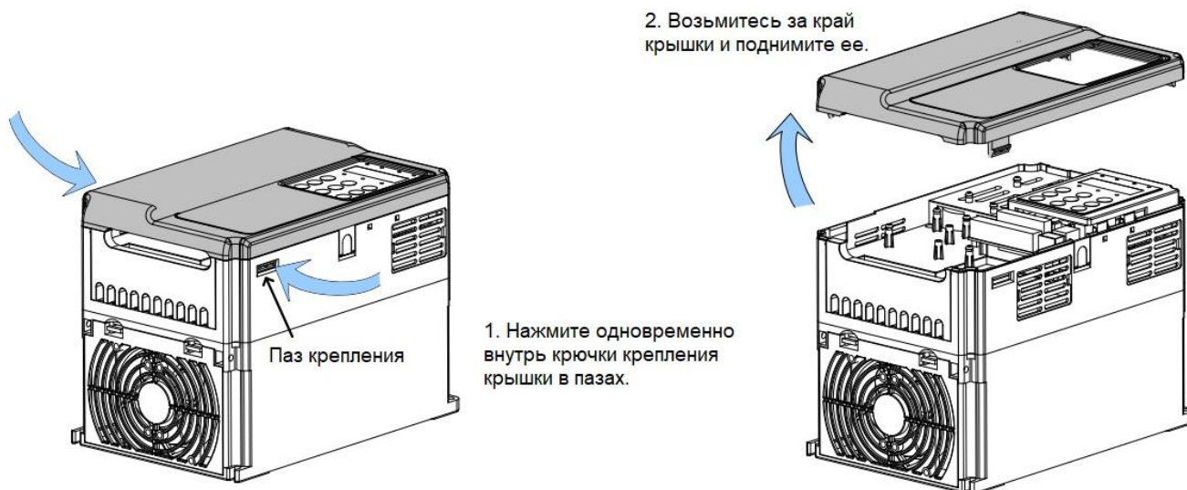
Рисунок 3–12 Снятие передней крышки устройства INVERTER (корпус из листового металла)
