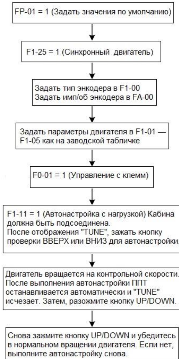
Рисунок 7-3 Блок-схема автонастройки синхронного двигателя с нагрузкой
