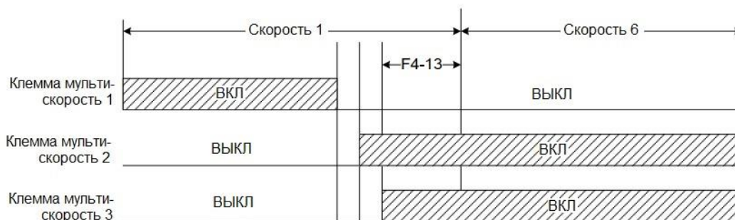
Рисунок 6-7 Схема переключения мульти-скорости
