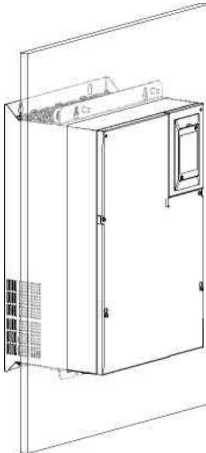
Рисунок 3–10 Результат сквозного монтажа устройства INVERTER (корпус из листового металла)
