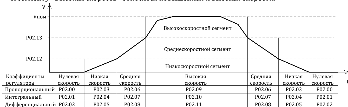
Рис.2 Сегментирование кривой движения лифта и показатели регулятора PID
