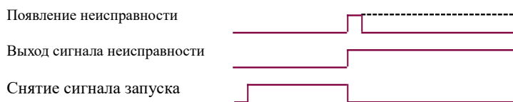
Рис. 6.9 Последовательность сигналов неисправности
