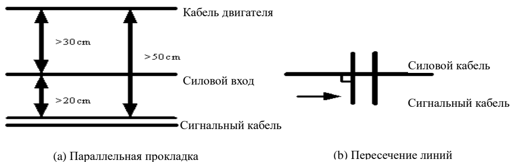
Рис. A.3 Требования к проводке
