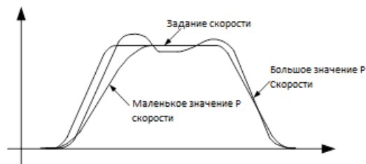
Рис. 7.10 Константа пропорции P влияет на кривую обратной связи
