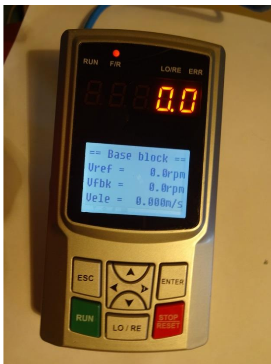
Рис. 5.1 Названия и функции частей пульта оператора
