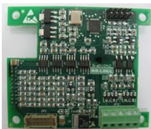
Рис. 4.37 Схема клемм для карты Endat Absolute PG
