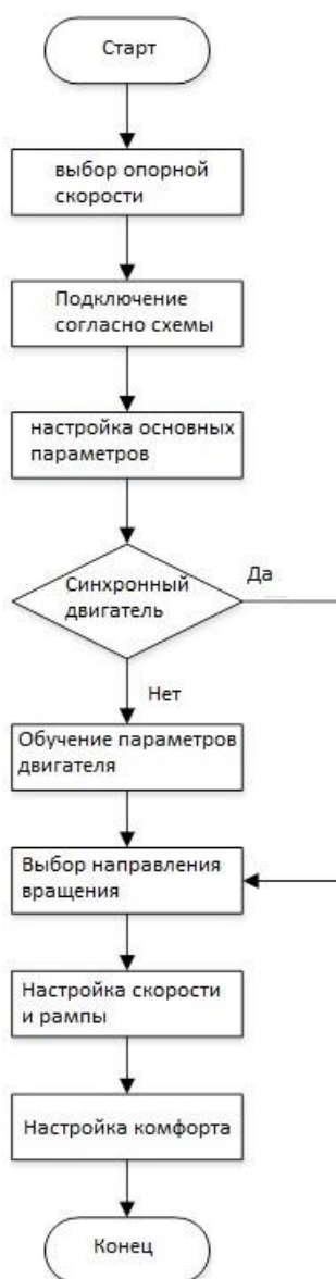
Рис. 7.1 Блок-схема управления инвертором серии AS620
