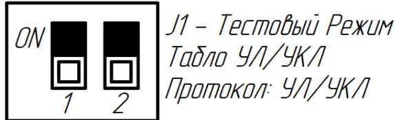
**Рисунок 2** Установка Тестового режима работы МКК. ТИ УЛ/УКЛ
