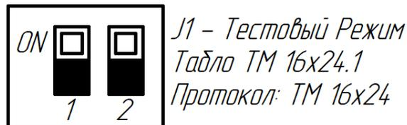
**Рисунок 3** Установка Тестового режима работы МКК. ТИ ТМ 16x24.1
