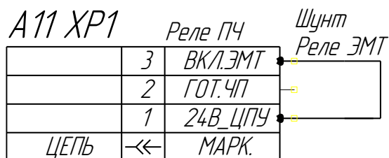
Рисунок 8 Модуль А11. Шунтирование Реле ЭМТ в ПЧ
